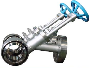
الطرز SPD 2500psi-10"/8"BW x 3"/1.5" صمام تصريف مغلف من الطراز الأفقي قرص المكبس يكون عرضي داخل الأنبوب.
