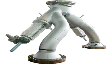
طراز W3Z صمام ثلاثي الشعب عازل 150psi-34"28" x 28"24" توصيل مع حافة الأنبوب مغلف، تشغيل بواسطة محرك كهربائي
