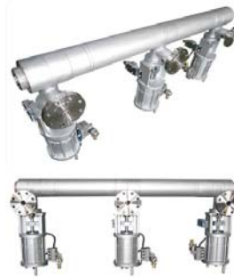
الطرز 3IJF 300psi-6"/4" BW x 3"/1.5RF صمام حقن ثلاثي من الطرز ثلاثي الصمامات يتم تشغيله باسطوانة هوائية
