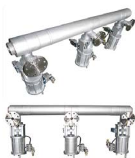
тип 3IJF 300 на ф/дм 2 изб.-6"/4"BW x 3"/1.5RF Тройной инжекционный клапан с пневматическим приводом строеной конструкции
